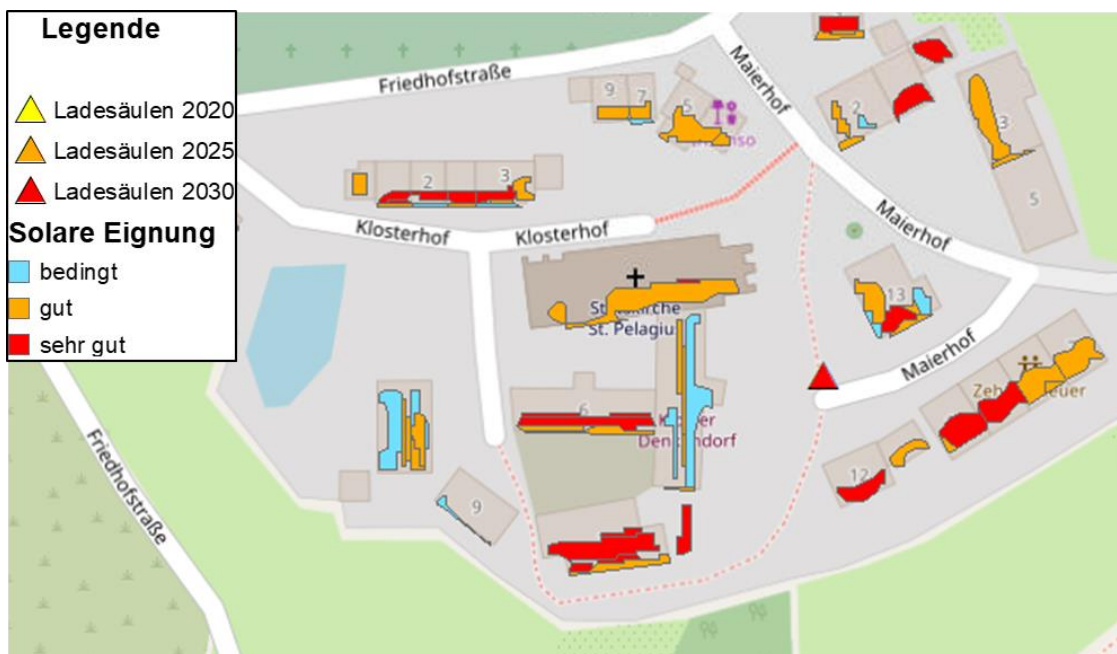
Abbildung 12-14: Solarpotential Dachflächen Kloster Denkendorf (Quelle: LUBW)
